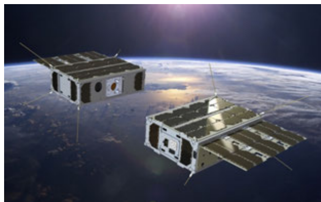
Figura 2: Misi3n RACE con Cubesats tipo 6U para demostrar operaciones de aproximaci3n y acoplamiento. (Fuente:ESA)
