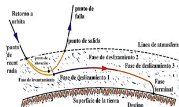
Figure 1. Fases del esquema especial de vuelo de reentrada y Lift-Drage de la aerodinámica de vuelo.
