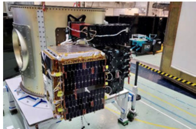
Figura 4: PocketPODs montados en anillo completo (Fuente: Exolaunch)
