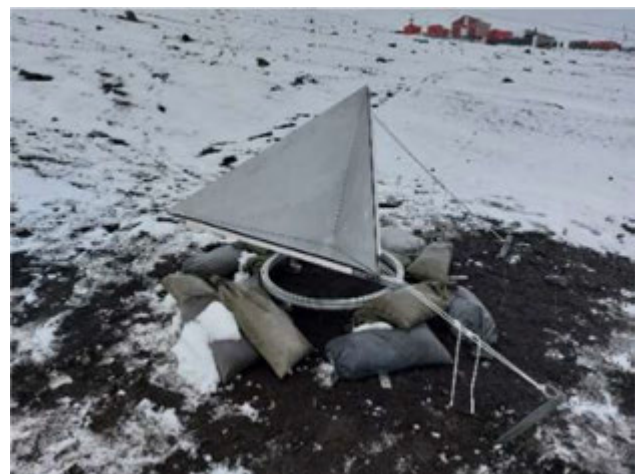
Figura 1: Instalación de reflector de esquina sobre su estructura base en Isla Decepción (INTA).
