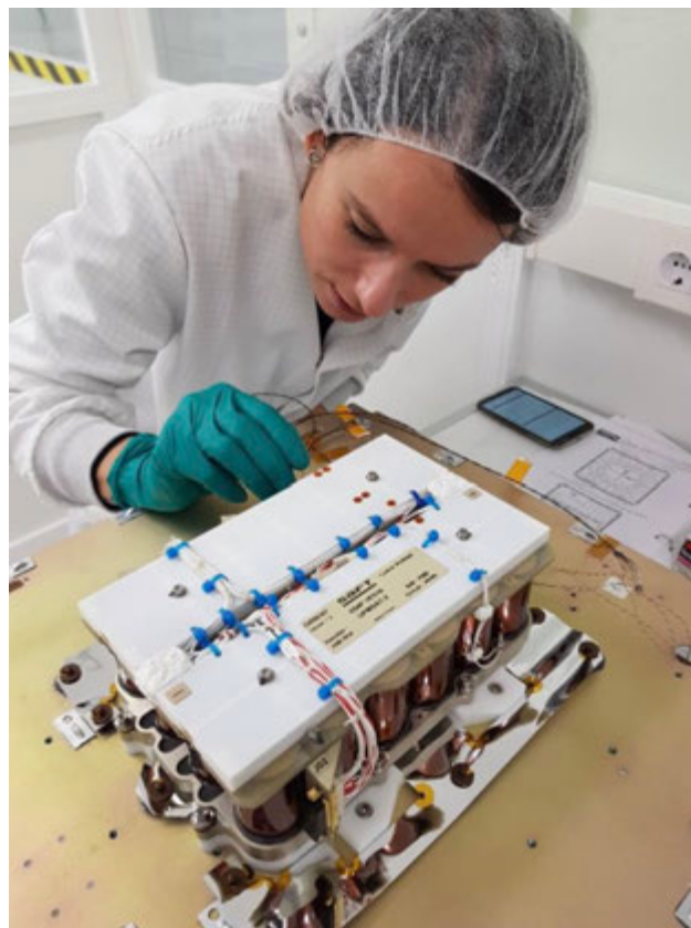
Figura 4. Batería del UPMSat-2 integrada sobre la bandeja C del satélite. La integración fue dirigida por los profesores de la UPM Elena Roibás-Millán (en la foto) y Javier Pérez-Álvarez.
