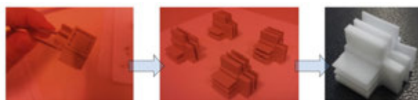
Figura 1: Distintas fases del proceso: pieza tras impresión 3D (izquierda) y pieza final sinterizada (derecha)
