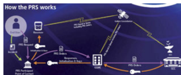
Figura 1: Infraestructura de explotación del servicio PRS (Fuente: INTA)
