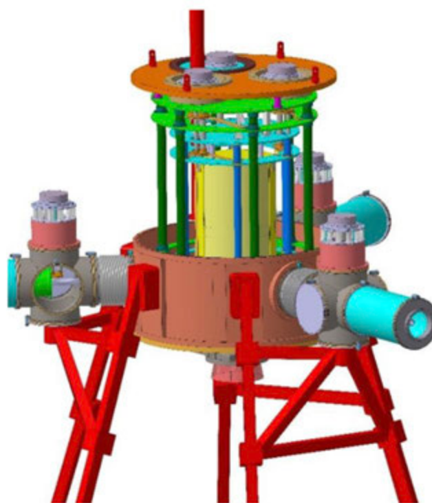
Figura 1: Diseño Conceptual-Preliminar del criostato C2CC (Fuente: INTA)
