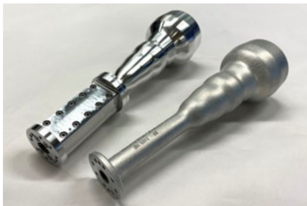
Figura 1. Fotografía del prototipo de cadena radiante para la banda Ka fabricado mediante SLM en metal comparado con su homóloga fabricada por CNC.
