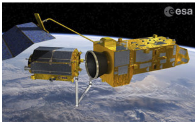
Figura 1: Misi3n e.Deorbit en el momento de la captura del Sat3elite mediante un brazo rob3tico (Fuente:ESA / David Ducros)
