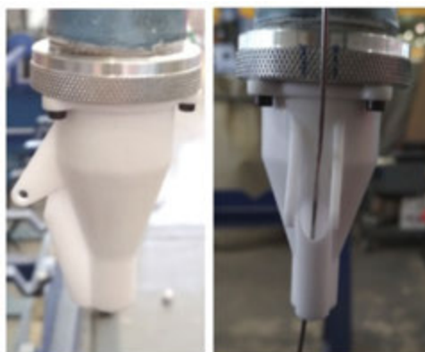
Figura 2: Demostrador de componente para sector bienes de equipo (alúmina)
