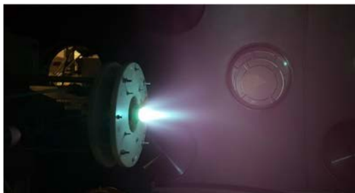
■ Ignición del prototipo HIPATIA con imanes permanentes en las instalaciones de la UC3M en Leganés.
