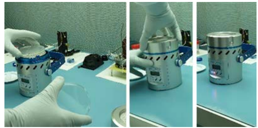
■Figura 5. Operación de un muestreador de aire biológico: a) se carga con una placa, b) se tapa y c) se pone a impactar el aire exterior contra la placa
