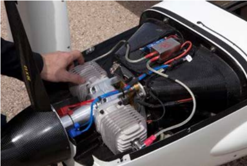
■ Figura 1. Sistema moto-propulsor del RPA D-80, desarrollado por DEIMOS, junto con los sensores de estado (incluyendo tácometros duplicados)
