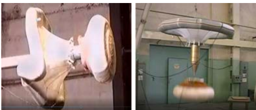
■ Fig. 2. Elementos inflables de MetNet, reutilizados en MINS, durante ensayos de despliegue (TIBU) y suelta (HIBU).
