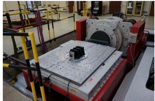
■ Figura 7: DRAGO sobre la plataforma de vibraciones en las instalaciones del INTA en Torrejón de Ardoz.
