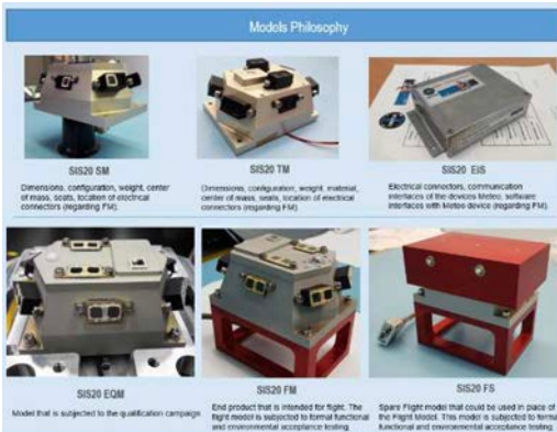
■ Filosofía de modelos del sensor RDM-SIS'20.
