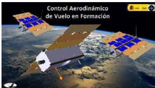
■ Fig. 2 Imagen de tres Cubesat (3U) con control aerodinámico de vuelo en formación
